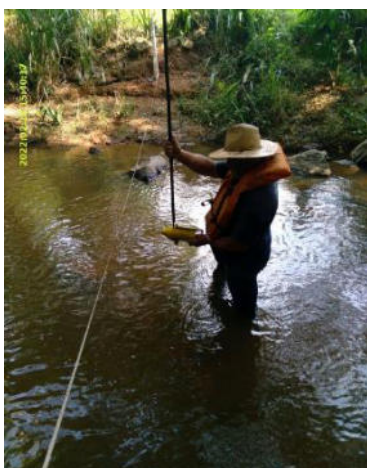
Foto 3 – Amostragem de Sedimento do Fundo no PSED. (Data: 15/02/2022).
