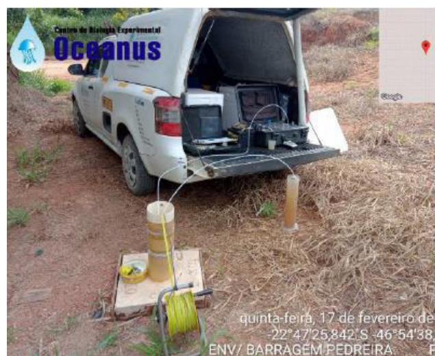
Foto 2 – Amostragem de poço de monitoramento PM-04 no dia 16/02/2022.
