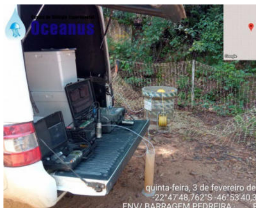
Foto 2. Foto evidenciando equipamentos utilizados para a amostragem em baixa vazão. PM-03.
