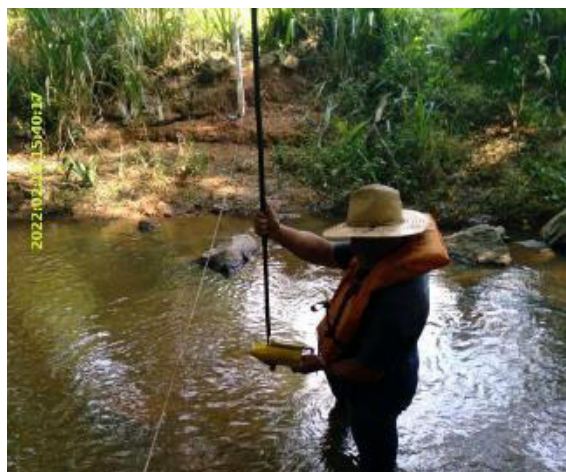
Foto 3 – Amostragem de Sedimento do Fundo no PSED. (Data: 15/02/2022).
