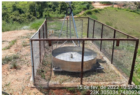
Foto 4 – Tanque do reservatório sendo preenchido com água. (Data: 15/02/2022).
