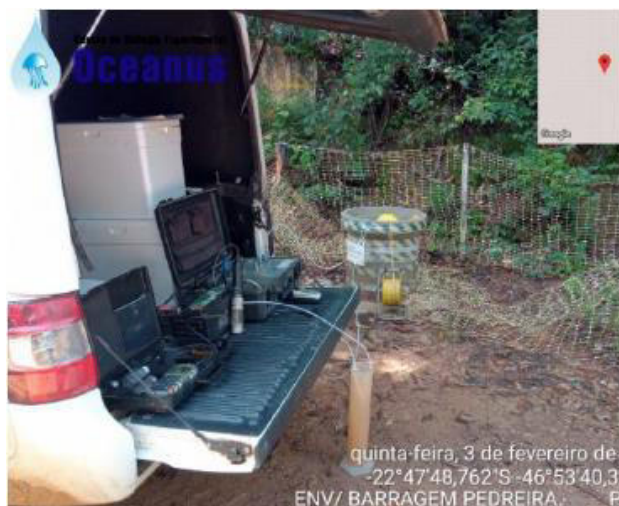
Foto 1 – Amostragem em baixa vazão PM-03 no dia 03/02/2022.
