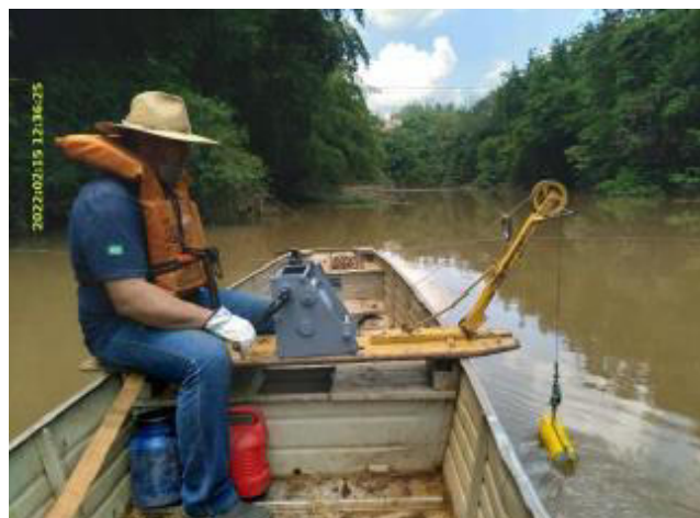
Foto 4 – Amostragem de Sedimento em Suspensão no PHJ. (Data: 15/02/2022).
