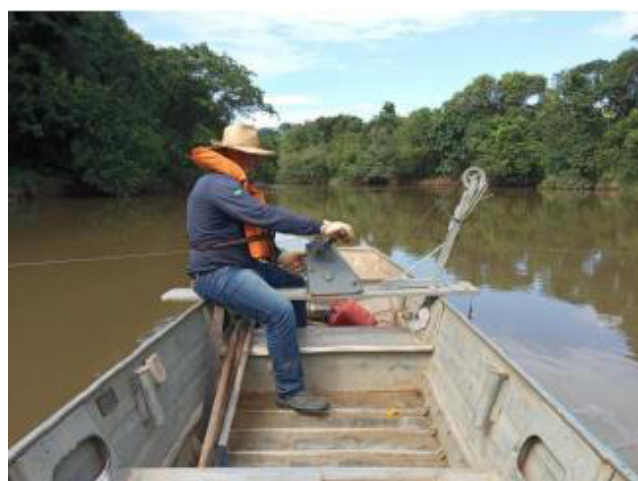
Foto 6 – Medida de descarga líquida no PHM (Data: 28/03/2022).
