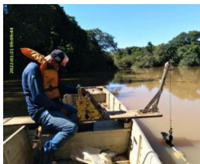
Foto 2 – Medida de descarga líquida no PMH (Data: 21/01/2022).
