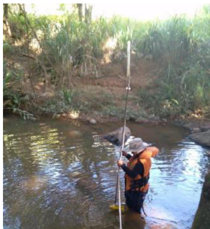
Foto 7 – Amostragem de Sedimento em Suspensão no PSED. (Data: 23/04/2022).
