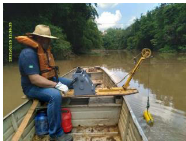
Foto 4 – Amostragem de Sedimento em Suspensão no PHJ. (Data: 15/02/2022).
