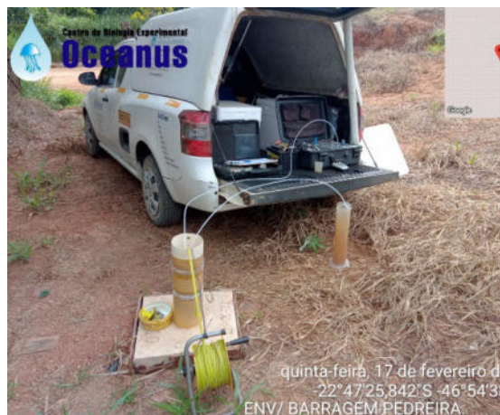
Foto 5. Foto com ênfase no processo de amostragem de água subterrânea no PM-10.
